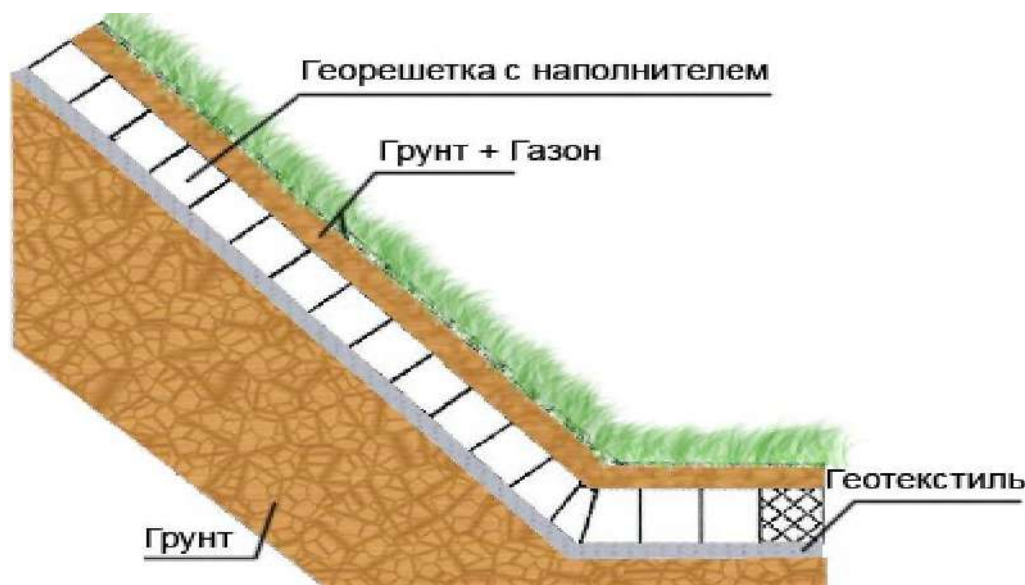
Рисунок 2. Укреплении откосов земляного полотна с применением объемных георешетка.
